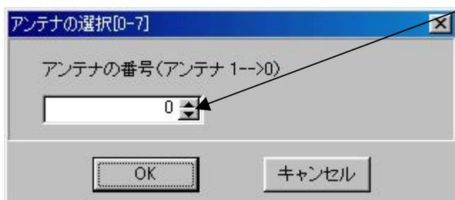
外部アンテナの自動切替え機能が無効の場合、上位側からアンテナを指定します。
