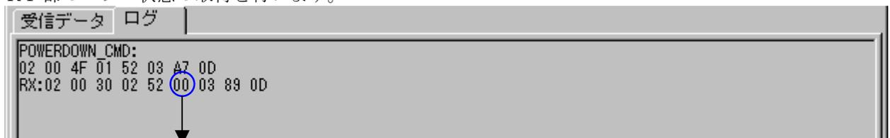
bit0 : 1 --> TX OFF (キャリア出力OFF) 状態      0 --> TX ON (キャリア出力ON) 状態
