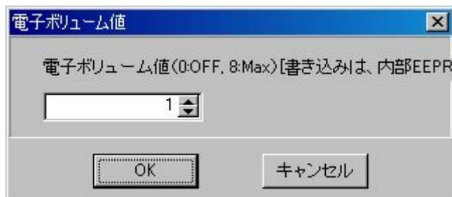
上位側からスピーカーの音量を変更する場合に使用します。再度、電源を ON した場合にも有効となります。
