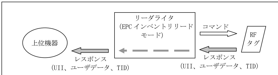
ISO/IEC18000-3(Mode3)対応 RF タグの、UII データと指定メモリバンクのデータを読み取るモードです。
