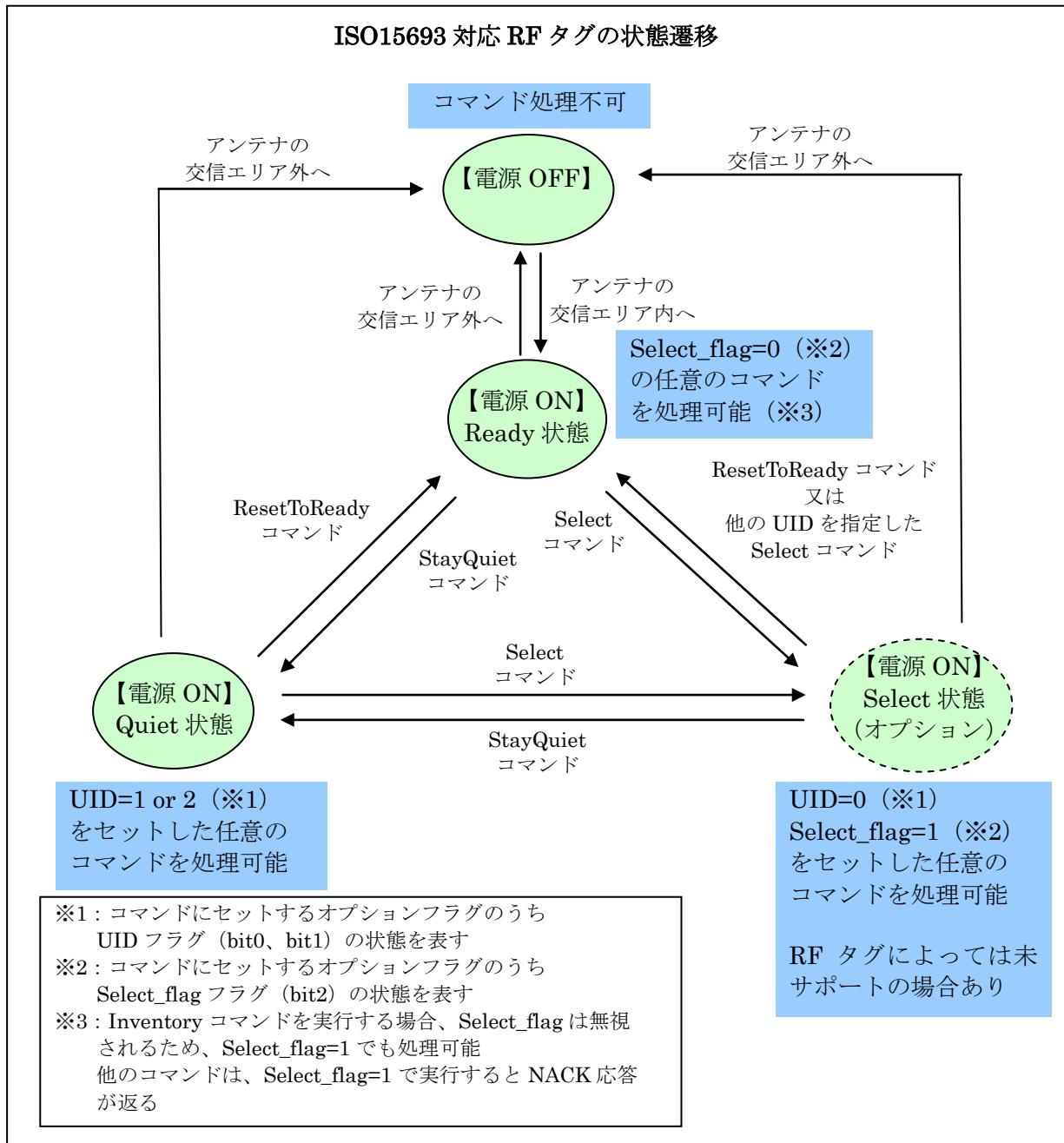
RFタグは、アンテナの交信エリアに入ると必ず Ready 状態で起動します。
