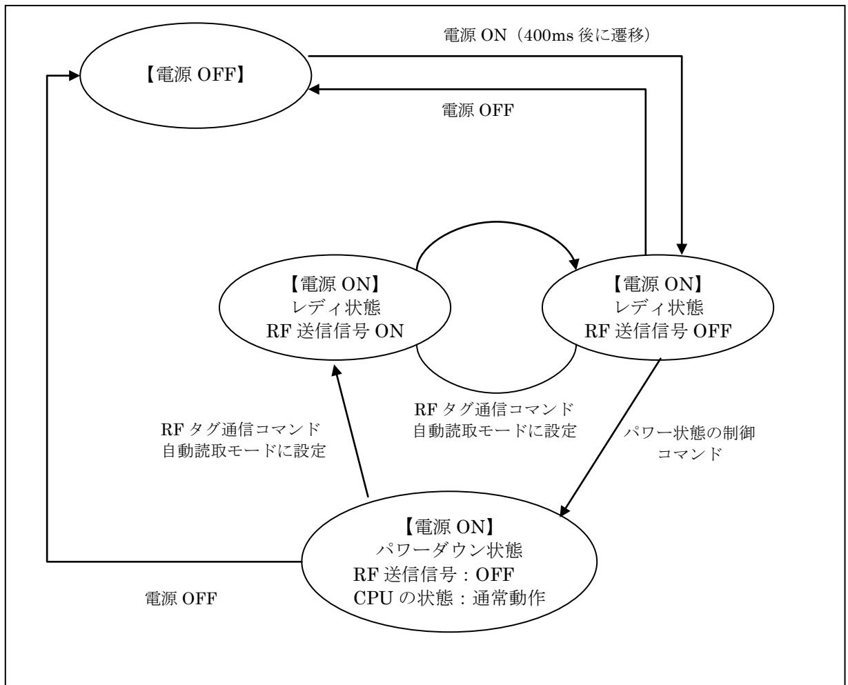
リーダライタは、電源起動後は「レディ状態：RF送信信号OFF」の状態で立ち上がります。RF送信信号設定が「コマンド実行時以外常時OFF」に設定されているリーダライタは、RF送信信号の制御コマンドを受け付けません。(NACK応答となります)
