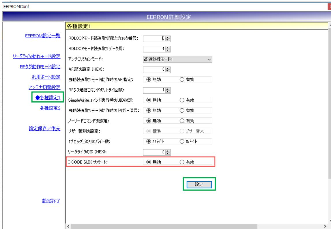
旧機種種で[ICODE SLIX サポート]が[有効]に設定されている場合は、新機種種を[S6700 互換モード]で使用する際には、新機種種でも必ず[ICODE SLIX サポート]を[有効]に設定してください。
