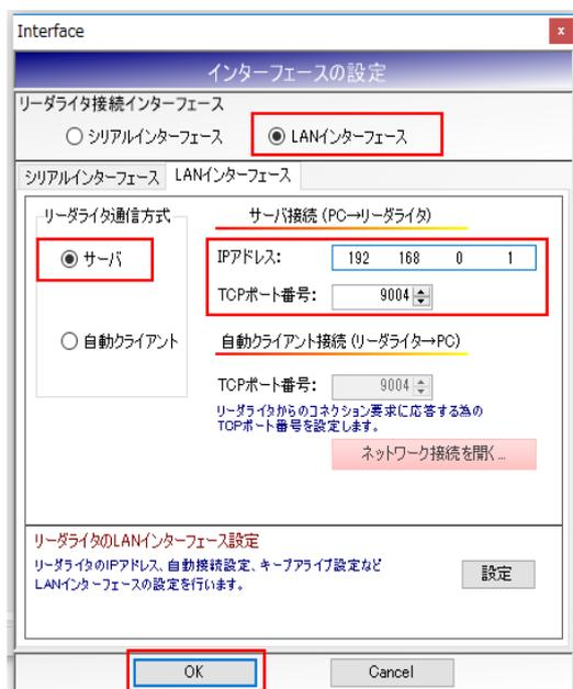
PC 側のネットワーク設定の方法が分からない場合は、「TR3RWManager 取扱説明書 (据置型/モジュール製品編)」の「3.2 TCP/IP 通信」をご参照ください。
