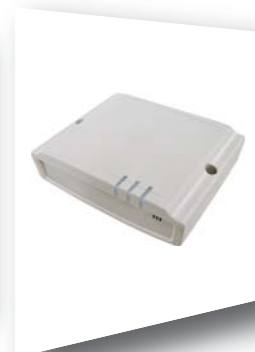
時限解除器 IN-RAT-S サイズ：140×110×38.5mm
