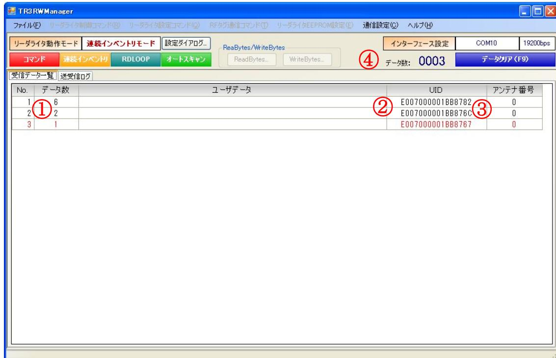
※3：アンテナ番号とは、切替基板を使用し複数のアンテナを制御するときの番号です。「0」は切替基板の1番目に接続されているアンテナを表しますが、切替基板を使用していない場合も「0」で表示されます。
