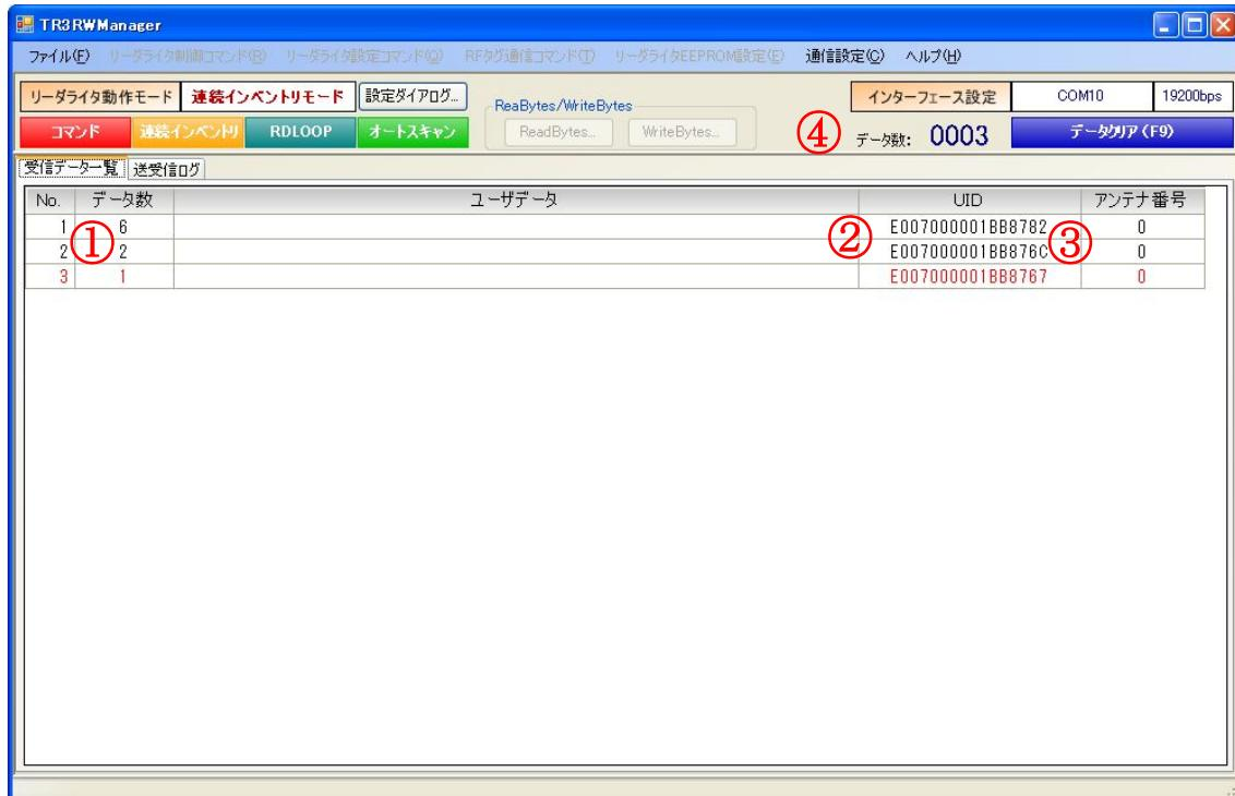
※2：アンテナ番号とは、切替基板を使用し複数のアンテナを制御するときの番号です。「0」は切替基板の1番目に接続されているアンテナを表しますが、切替基板を使用していない場合も「0」で表示されます。
