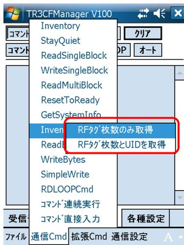
次の画面は、アンテナの発信範囲内に 3 枚の RF タグが滞在している場合に「RF タグ枚数のみを取得」を実行した様子を示しています。
