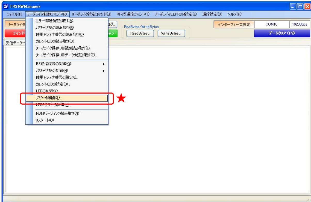
なお、本コマンドでブザーを制御するためには、リーダライタの汎用ポート7の機能が「ブザー制御信号出力ポート」に設定されている必要があります。
