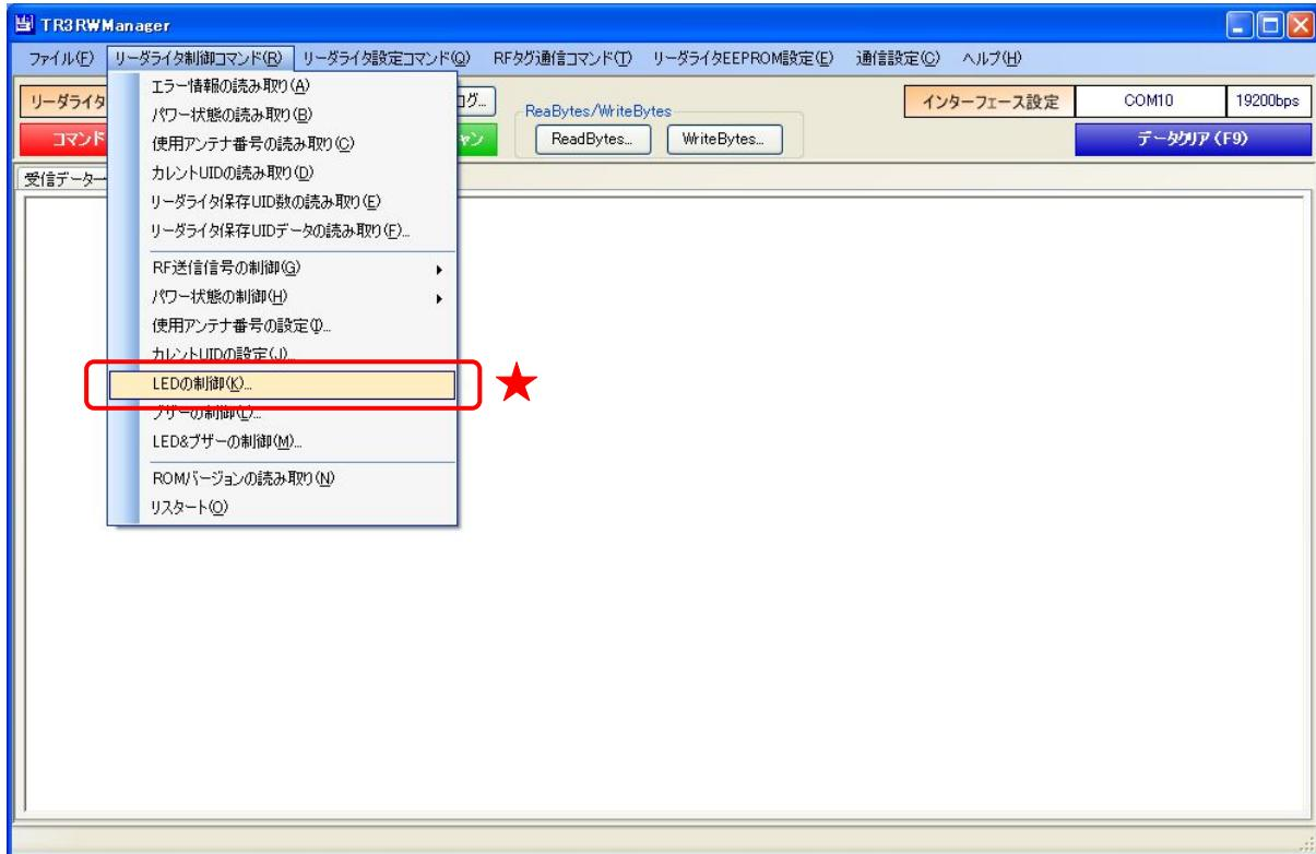
なお、本コマンドで LED を制御するためには、リーダライタの汎用ポート 1 の機能が「LED 制御信号出力ポート」に設定されている必要があります。
