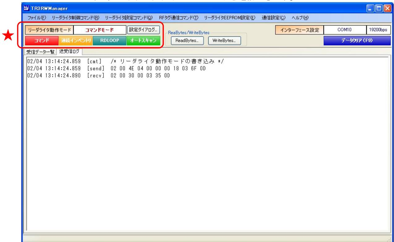
リーダライタ動作モードがコマンドモード以外（連続インベントリモード・RDLOOPモードなど）に設定されている場合は、各種メニューが使用不可となります。
