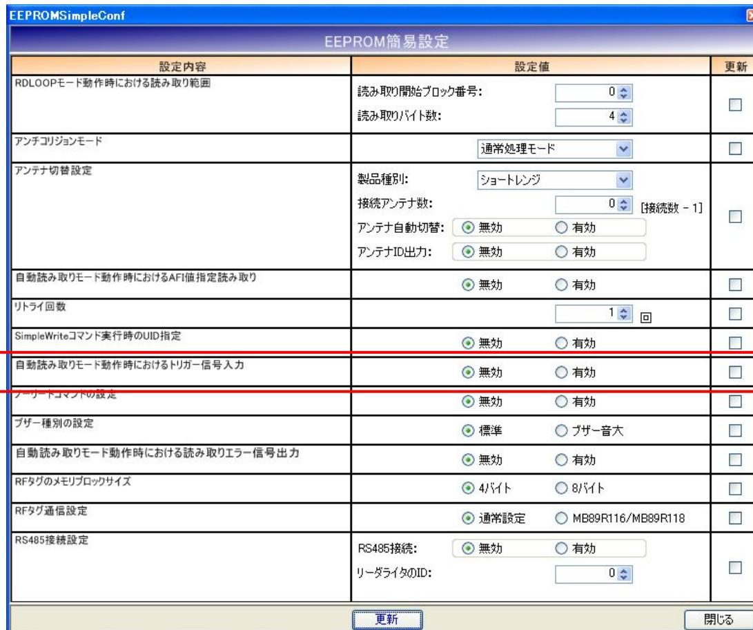
本設定値を「有効」に設定した場合は、トリガー信号未入力時には RF タグの読み取りを行わず、トリガー信号入力時にのみ RF タグの読み取りを行います。
