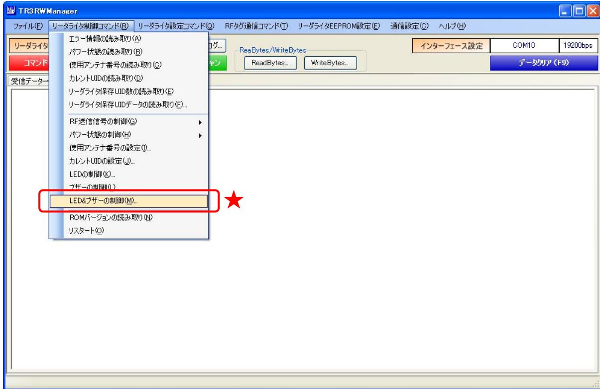
なお、本コマンドで LED&ブザーを制御するためには、リーダライタの汎用ポート 1 および汎用ポート 3 の機能が「汎用ポート」に設定されている必要があります。
