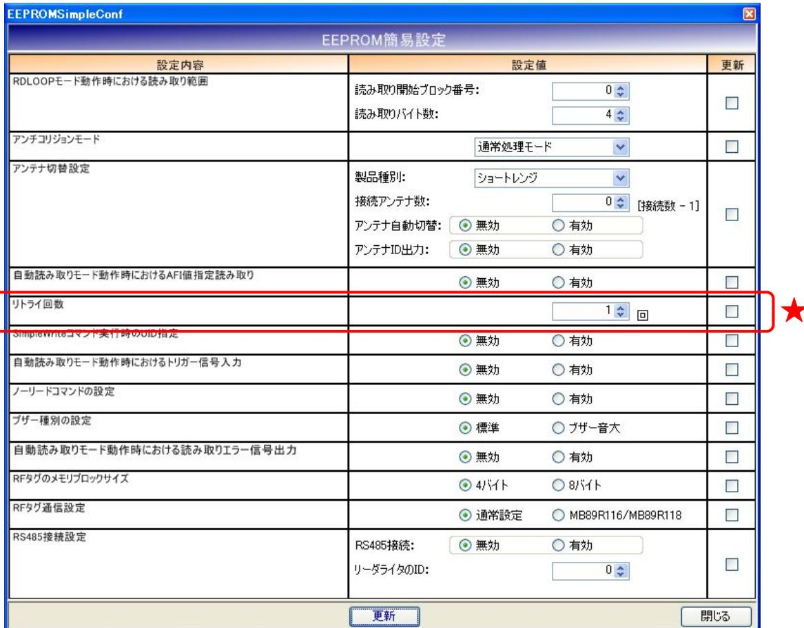
本設定値は上位システムからの1回のコマンド指示に対してリーダライタが実行するコマンドの最大試行回数を設定します。
