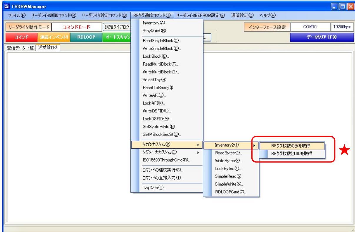
次の画面は、アンテナの交信範囲内に3枚のRFタグが滞在している場合に「RFタグ枚数のみを取得」を実行した様子を示しています。
