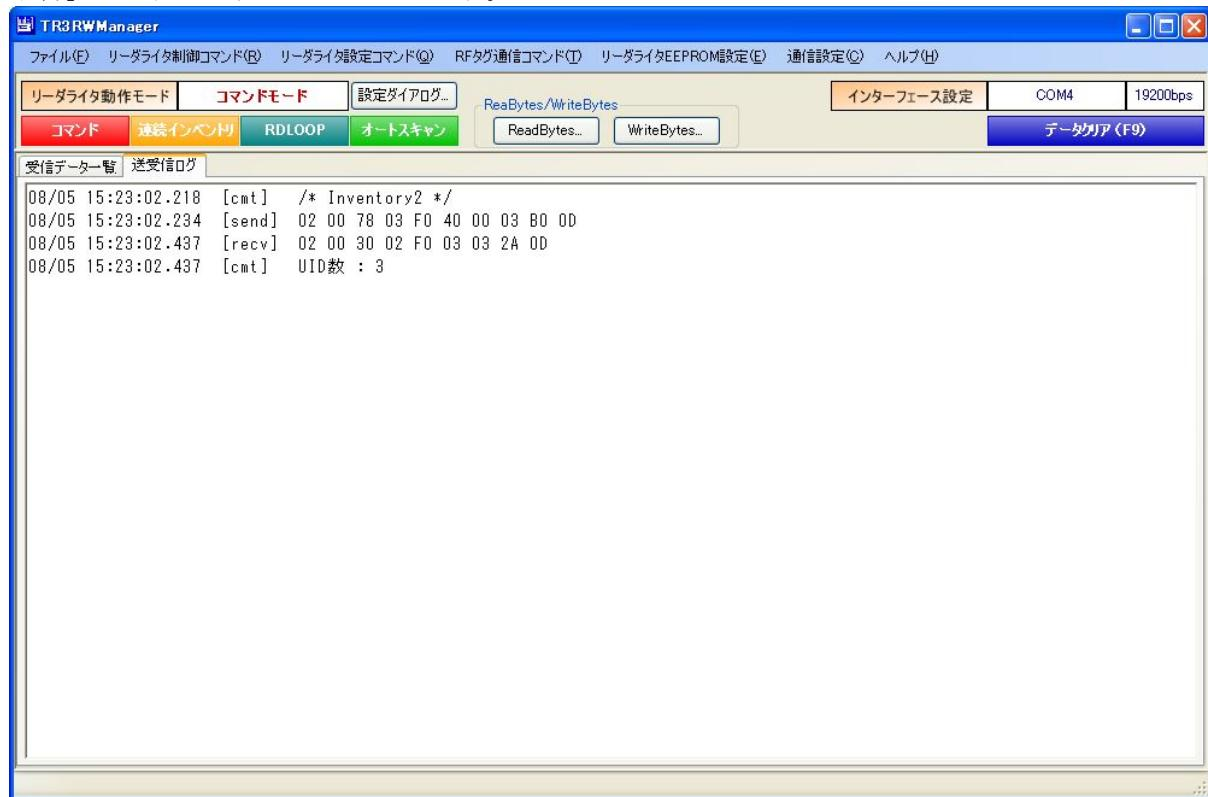
次の画面は、アンテナの交信範囲内に3枚のRFタグが滞在している場合に「RFタグ枚数とUIDを取得」を実行した様子を示しています。
