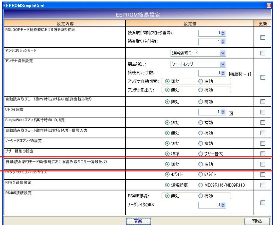
本設定値は、コマンドモード以外のリーダライタ動作モード（連続インベントリモード、RDLOOP モードなど）においてアンチコリジョン設定を「無効」としている場合のみ適用されます。
